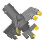
Со сменными плоскими резцами R-35, торцы лопастей усилены твёрдосплавными зубками (восьмигранниками). D = 420, 530 мм.
