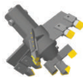
Со сменными плоскими резцами R-35, торцы лопастей усилены твёрдосплавными зубками (шестигранный тип). D = 420, 530 мм.
