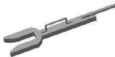
**Хомуты** предназначены для спуска и подъема колонн обсадных труб и поддержания колонн труб на весу при спуско-подъемных операциях.
