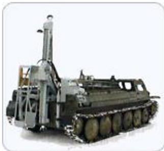
**Буровая установка УБС-Г0(01) «Сейсмик»** с гидравлическим приводом подвижного вращателя. Предназначена для бурения вертикальных сейсморазведочных скважин в породах до IV категорий по буримости, включая мерзлые и вечномёрзлые породы при температуре до - 40 °С. Установка монтируется на гусеничном снегоболотоходе ГАЗ-34039.
