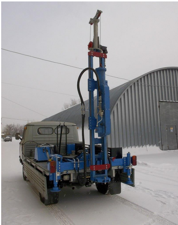
Рис. 5 Комплекс КДЗ-003 с устройством динамического зондирования
