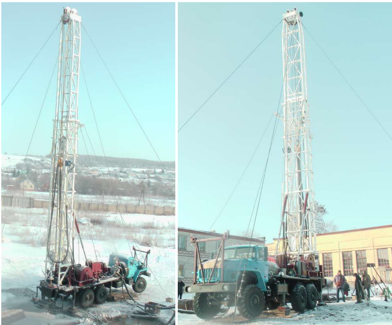
Буровая установка УРБ-40 на шасси УРАЛ-4320.
