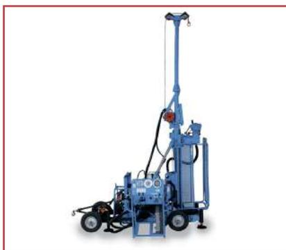
**Буксировочная тележка** предназначена для перемещения установки на объекте.
