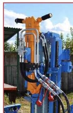
**Гидромолот** предназначен для погружения забивных грунтоносов диаметром до 121 мм при отборе образцов ненарушенной структуры для инженерных изысканий в строительстве.
