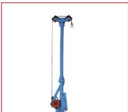
**Мачта с гидроприводной лебедкой** для вспомогательных операций с бурильными и обсадными трубами. Грузоподъемность 400 кг.
