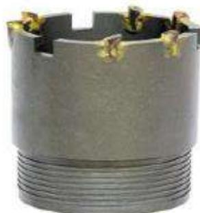
ТС-коронки предназначены для бурения в разрыхленных (раздробленных) породах. По требованию заказчика ТС-коронки могут быть изготовлены различных типоразмеров и стандартов.
