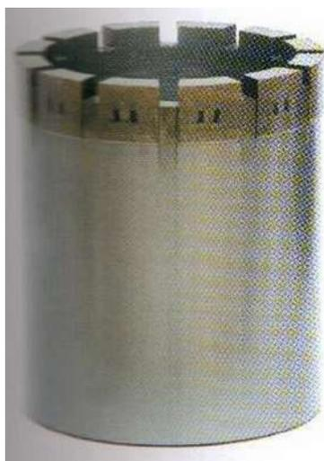
Буровой и обсадной башмак соединяется с концом буровой штанги или обсадной колонны. Это помогает направлять и стабилизировать колонну буровых и обсадных труб, обеспечивая защиту от повреждений при спуске в скважину и выходу бурового раствора на поверхность. Внутренний диаметр буровых и обсадных башмаков находится на одном уровне или имеет зазор к внутреннему диаметру бурильной и обсадной трубы, который дает свободный проход колонковому буру.
