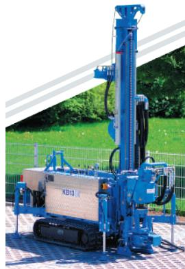
Ширина/ Высота в рабочем положении: 780-1000/ 3760 и 5060 мм с удлинителем)
